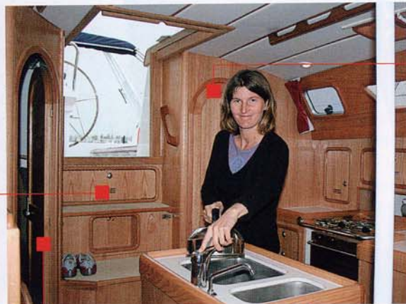
DEVANT LA CUISINIÈRE, LA HAUTEUR SOUS BARROT EST DE 1,87 M. L'USAGE DE LA POMPE À PIED À EAU DE MER N'EST PAS PRATIQUE, IL FAUT FAIRE LE GRAND ÉCART ENTRE LA POMPE ET L'ÉVIER.
