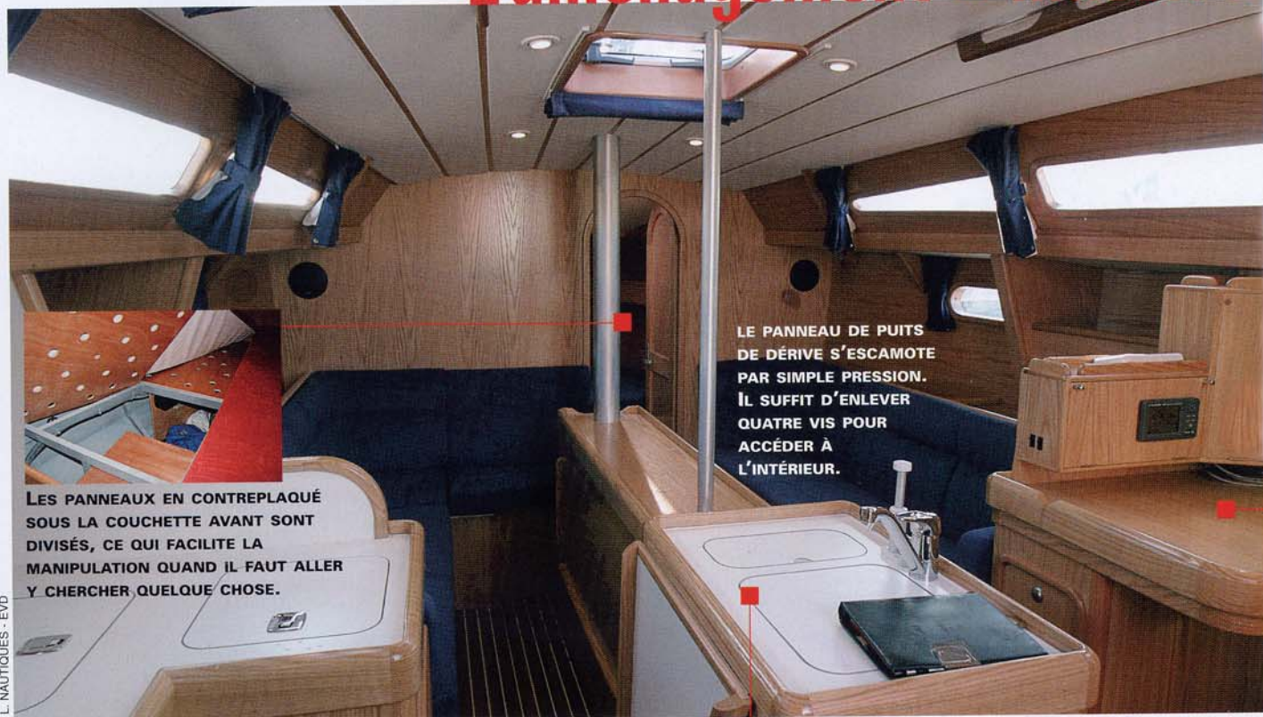
DEVANT LA CUISINIÈRE, LA HAUTEUR SOUS BARROT EST DE 1,87 M. L'USAGE DE LA POMPE À PIED À EAU DE MER N'EST PAS PRATIQUE, IL FAUT FAIRE LE GRAND ÉCART ENTRE LA POMPE ET L'ÉVIER.
