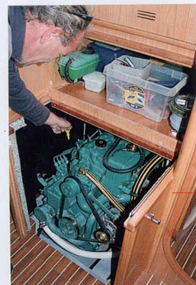
LA CAISSE À OUTILS PREND PLACE SOUS LA DESCENTE, TOUT COMME LE MOTEUR. POUR LES INTERVENTIONS SUR LES CÔTÉS, IL FAUDRA PASSER PAR D'AUTRES TRAPPES, SITUÉES DANS LES TOILETTES OU DANS LA CABINE ARRIÈRE.
