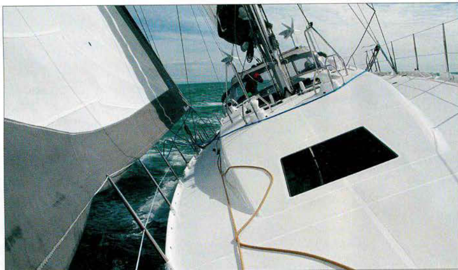
▲ Notez le pavois en aluminium et les emplacements de chandeliers non traversantes. C'est du solide, tout comme le revêtement antidérapant d'excellente qualité.
