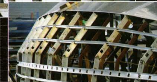
▲ Les lisses en « T » sont soudées au fond d'une encoche prévue dans les couples. Et pourquoi cette lisse en « U » ? Pour le passage des câbles.
