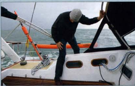
Pas pratique Très haute, l'hiloire s'avère franchement difficile à enjamber ; il faudrait prévoir de l'antidérapant sur la partie inclinée.
