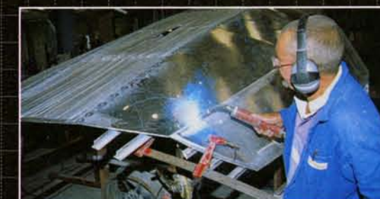
▲ Au moment de présenter la tôle, on commence par la fixer à la précédente grâce à une série de points de soudure à l'extérieur.
