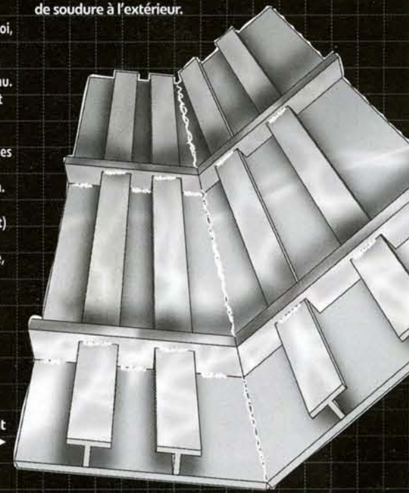
▲ Au moment de présenter la tôle, on commence par la fixer à la précédente grâce à une série de points de soudure à l'extérieur.
